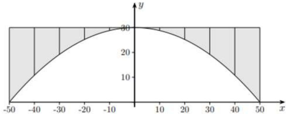
1. Eine Brücke ist 30 m hoch und hat eine Spannweite von 100 m. Welche Parabel beschreibt die Krümmung des Stützbogens?
